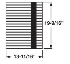
Laissez au moins 12 pouces entre l'aérotherme et le plancher, 12 pouces entre l'aérotherme et le mur adjacent le plus près et 36 pouces entre l'aérotherme et le plafond.
